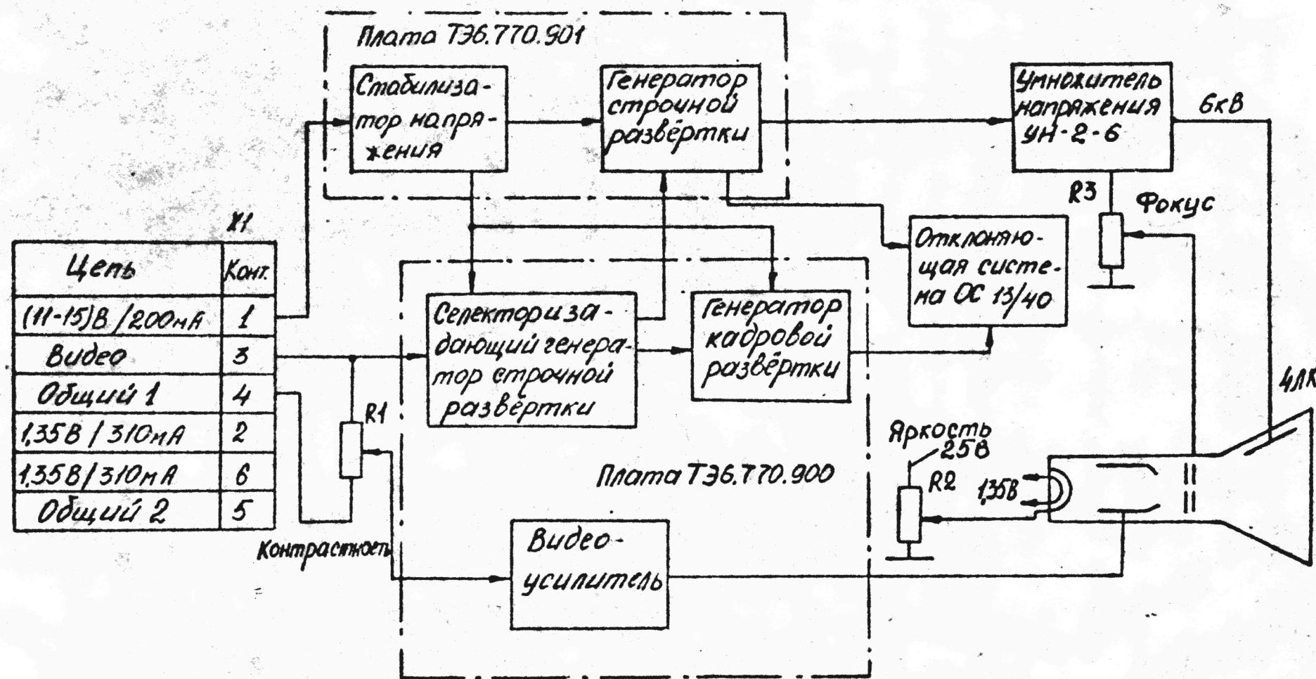
Рис. Структурная схема видоискателя ВИ-І
