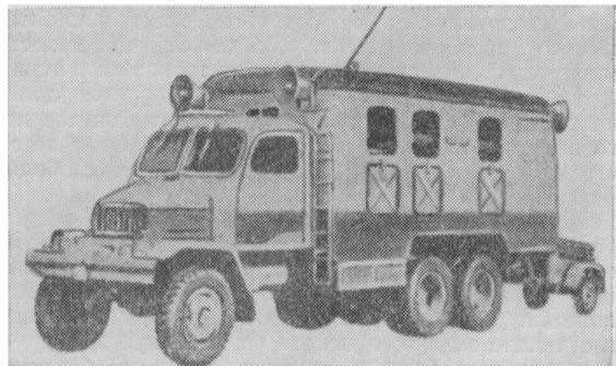
Применение автомобиля с шестью ведущими колесами и двигателем внутреннего сгорания с воздушным охлаждением позволяет использовать киноустановку в условиях пустыни и бездорожья.
