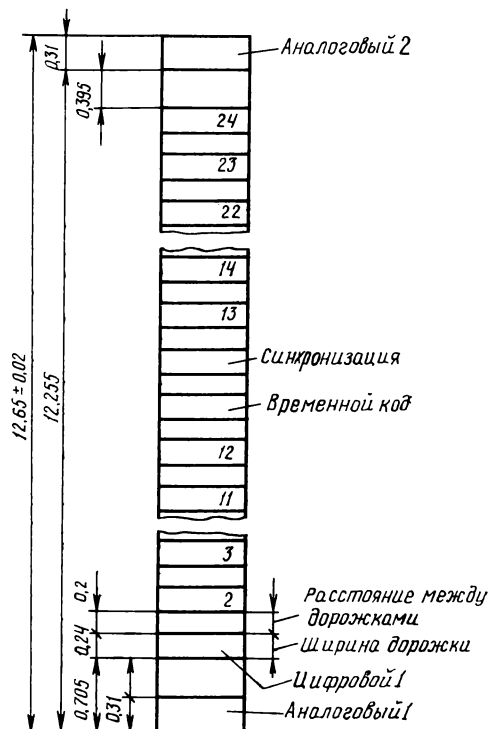
Рис. 1. Размеры и расположение дожек на магнитной ленте в магнитофоне PCM-3324
