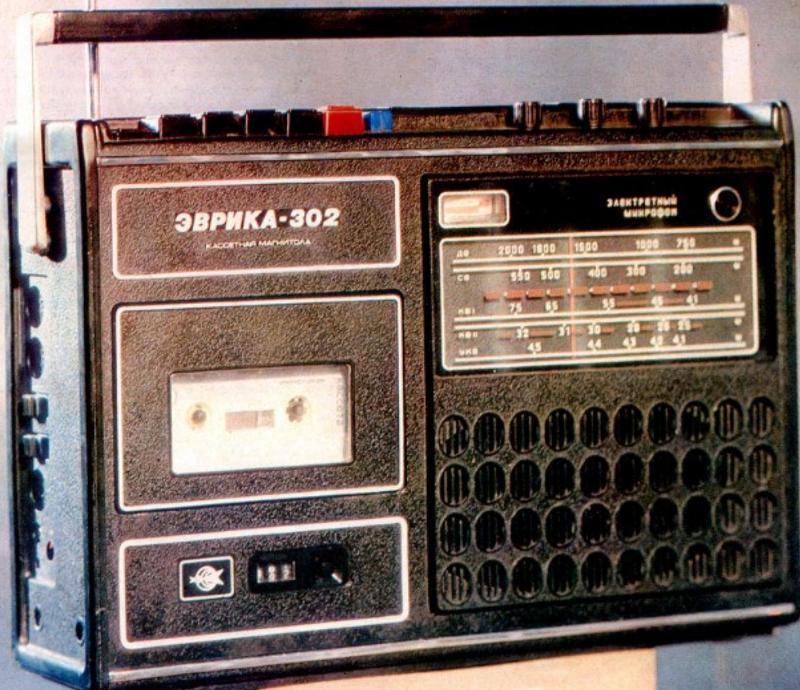
Переносная кассетная магнитола III класса «Эврика-302» представляет собой комбинированное устройство, состоящее из радиоприемника с широким диапазоном принимаемых волн (ДВ, СВ, КВ I и II, УКВ) и магнитофонной панели III класса для записи и воспроизведения звука на магнитную ленту в кассете типа МК-60.
