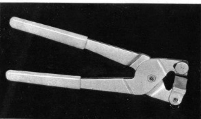
Ярославский завод дизельной аппаратуры приступил к выпуску стеклореза специального № 0400010. Он предназначен для резания листового стекла толщиной от 1 до 4 мм, а также керамической облицовочной плитки. Стеклорез оснащен тремя твердосплавными роликами; стойкость каждого без переточки — не менее
