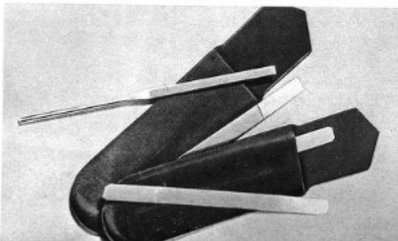
Экспертным советом Всесоюзного павильона одобрен к выпуску притир алмазный, представленный Рославльским заводом алмазного инструмента. Он предназначен для зачистки контактов прерывателей двигателей внутреннего сгорания, реле, а также других контактов из труднообрабатываемых палладиевых, серебряных и вольфрамовых сплавов.
