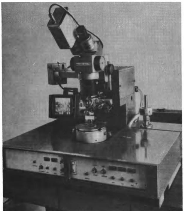
Рис. 1. Малогабаритная телевизионная установка МТУ-1 для монтажа ИС
