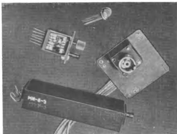
Квантово-электронные модули, применяемые в оптоволоконных системах информационного обмена
