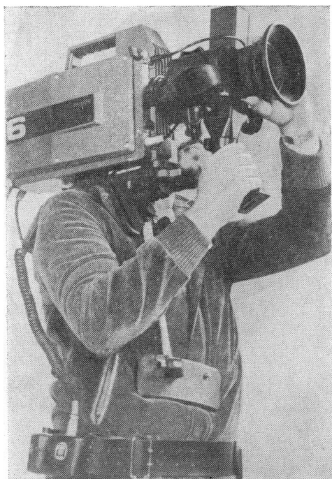
Рис. 4. Универсальная камерная система LDK-14 при автономной работе для ВЖ
