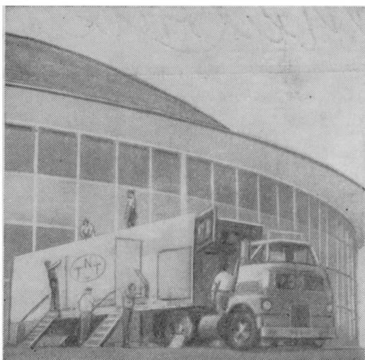
Рис. 1. Передвижная телевизионная установка
