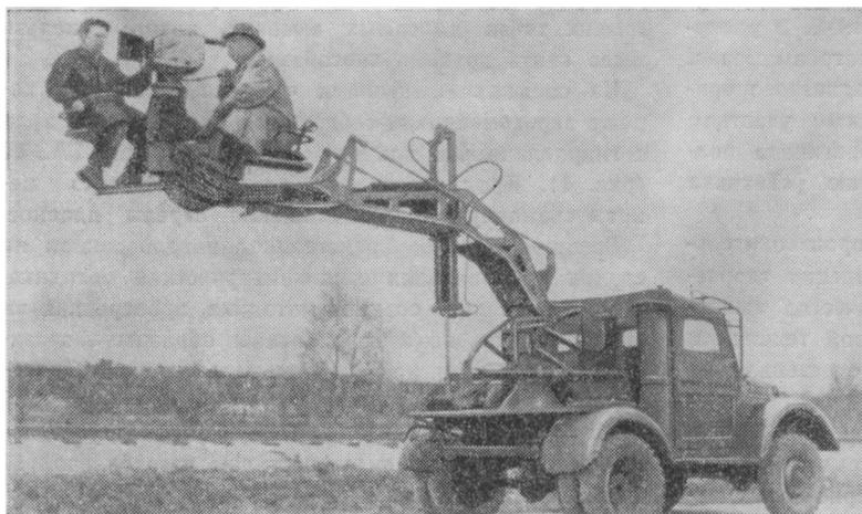
*Рис. 4. Сператорский кран с гидравлическим приводом на автомашине ГАЗ-69*
