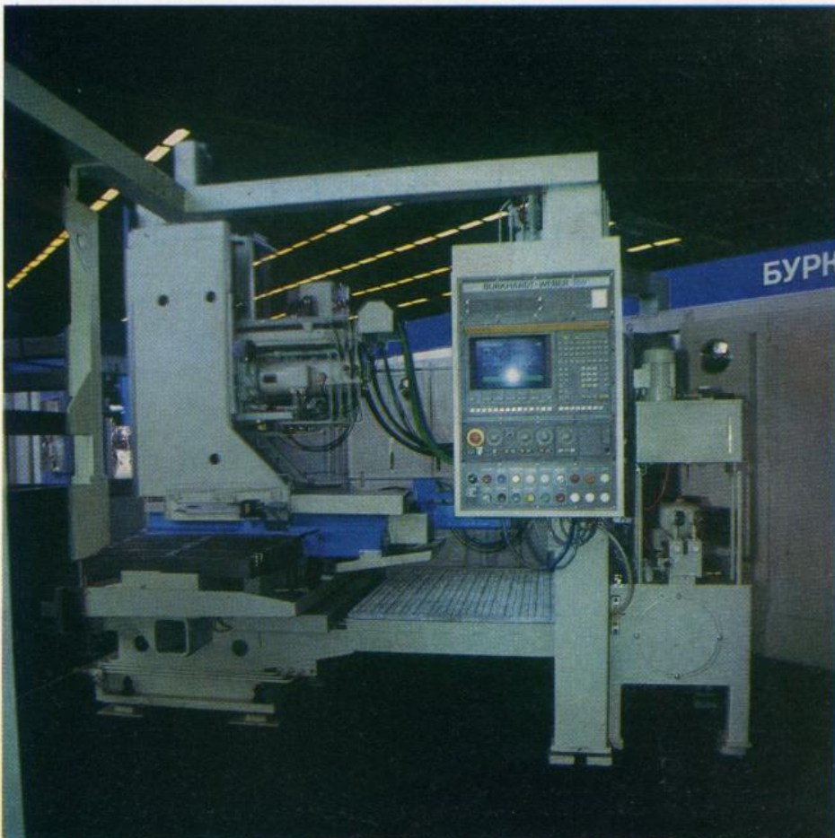
1. Обрабатывающая система с горизонтальным обрабатывающим центром «Парамат». Фирма Burkhardt+Weber
