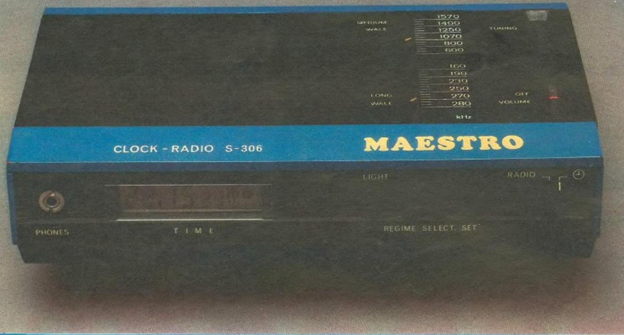
Это комбинированное устройство обеспечивает: индикацию текущего времени; автоматическое включение радиоприемника в заданное время и последующее отключение через 30 минут; автоматическое включение звукового сигнала в заданное время; звуковую индикацию начала каждого часа. Радиоприемник III группы сложности выполнен по супергетеродинной схеме и работает в диапазонах длинных и средних волн. Имеются гнезда для подключения мини-
