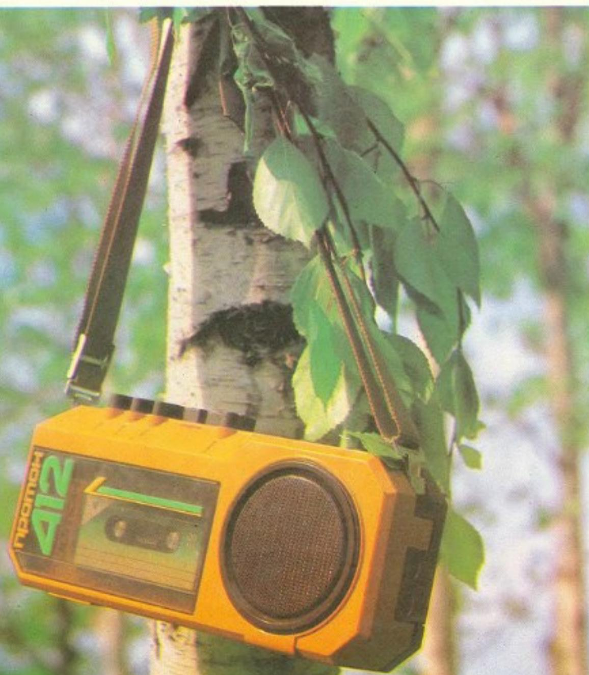
Односкоростной монофонический двухдорожечный магнитофон «Протон-411» оснащен системой автоматического регулирования уровня записи, имеет блокировочное устройство, предохраняющее запись от случайного стирания. Устройство кратковременной остановки ленты позволяет осуществлять комбинированные записи с контрольным прослушиванием через встроенный громкоговоритель. Питание — от сети 220 В, 50 Гц или 4 элементов «А343».
