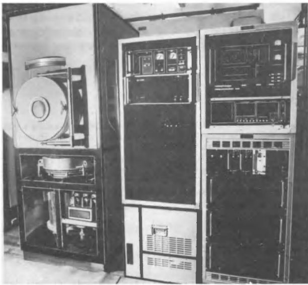
Рис. 2. Установка РИЛТ (внизу слева — насос ТМН-3500Х)
