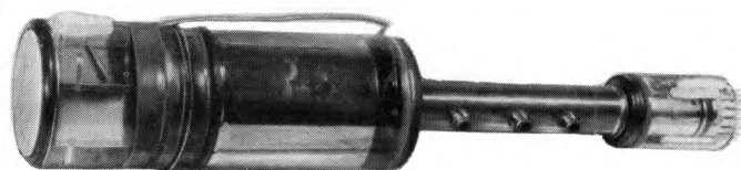
9 Широкополосный осциллографический ЭЛП 10ЛО105А с полосой пропускания 5 ГГц
