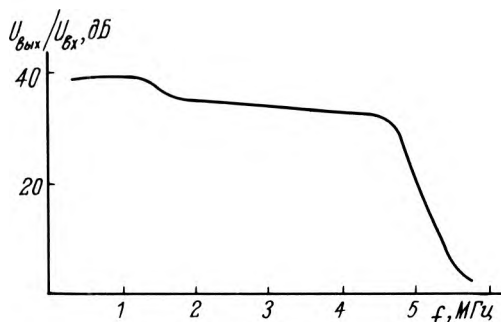
Рис. 3. Суммарная амплитудно-частотная характеристика тракта воспроизведения сигнала яркости
