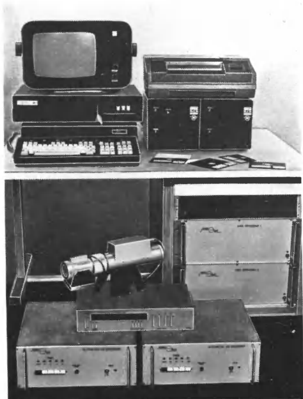
Рис. 1. Фрагмент системы, состоящей из измерительного преобразователя, двух устройств согласования, двух блоков управления и ДВК-2М
