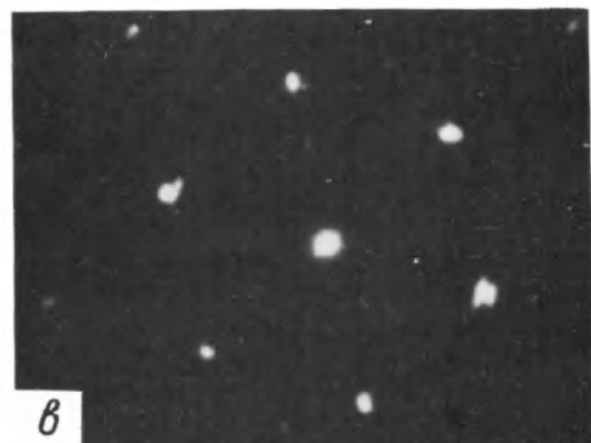
Рис. 3. Электронно-микроскопические снимки с увеличением \times 6000 (а); \times 20000 (б) и электронограмма (в) переходного слоя, образовавшегося на кремнии при пайке КП свинец–никель (температура 630 К, время выдержки 5 мин).
