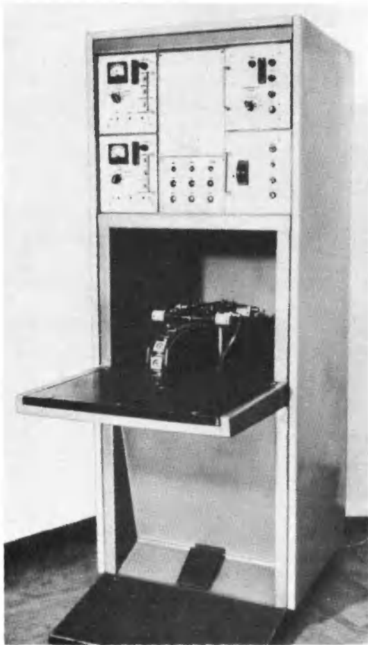
Рис. 2. Полуавтомат ОЗКС 700-1 конвейерного типа для герметизации плоских корпусов БИС
