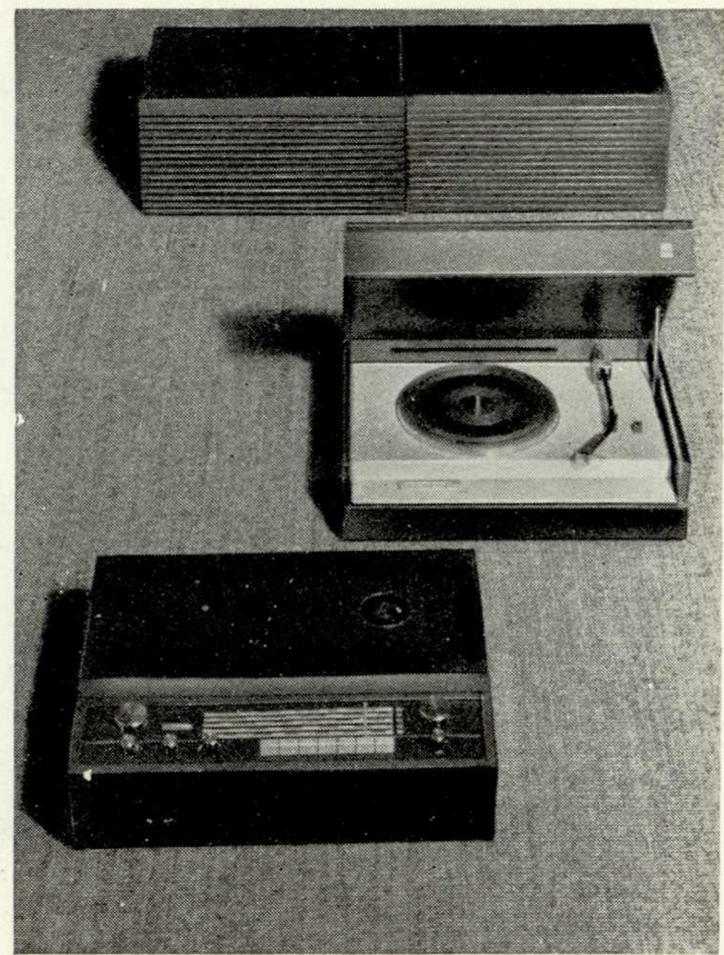
1, 2. Макет радиолы I класса, выполненный по блочному принципу. 3. Блоки радиолы I класса.
