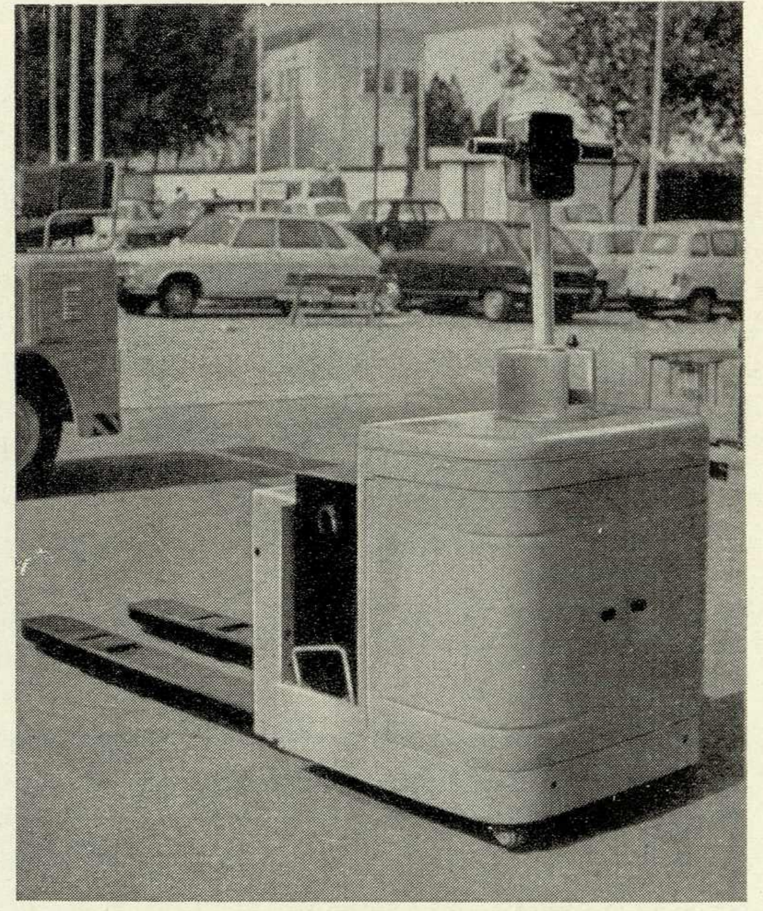
Электропогрузчик универсальный с рукояточным управлением. Дизайнеры М. Павлов, Е. Влчанова. Изготовитель — завод «6 Сентября», София, 1965.
