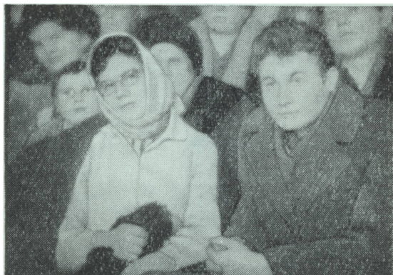
Рис. 4. Кадр, полученный при съемке в зрительном зале кинотеатра «Россия». Кинопленка типа В; чувствительность 100 ед. ГОСТа; F = 180 мм; диафрагма 4,5; освещенность 80—100 млк
