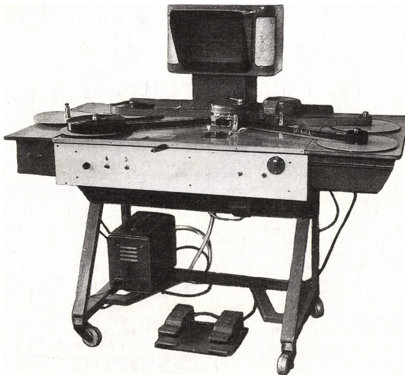
Рис. 1. Экспедиционный вариант звукомонтажного стола 35УЗМС-1
