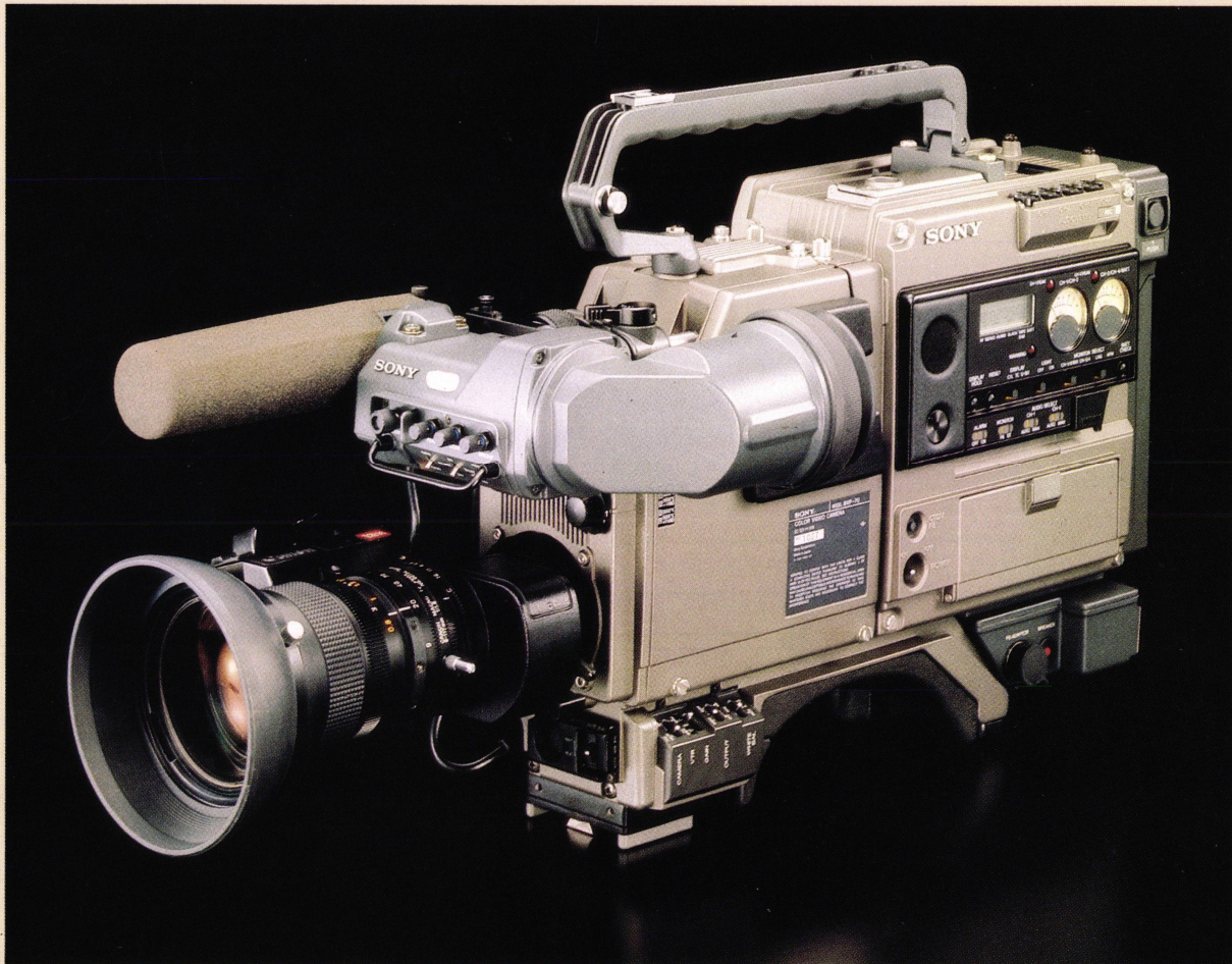
Betacam SP «BVW — 570P». Видеокамера на 3-х матрицах ПЗС
