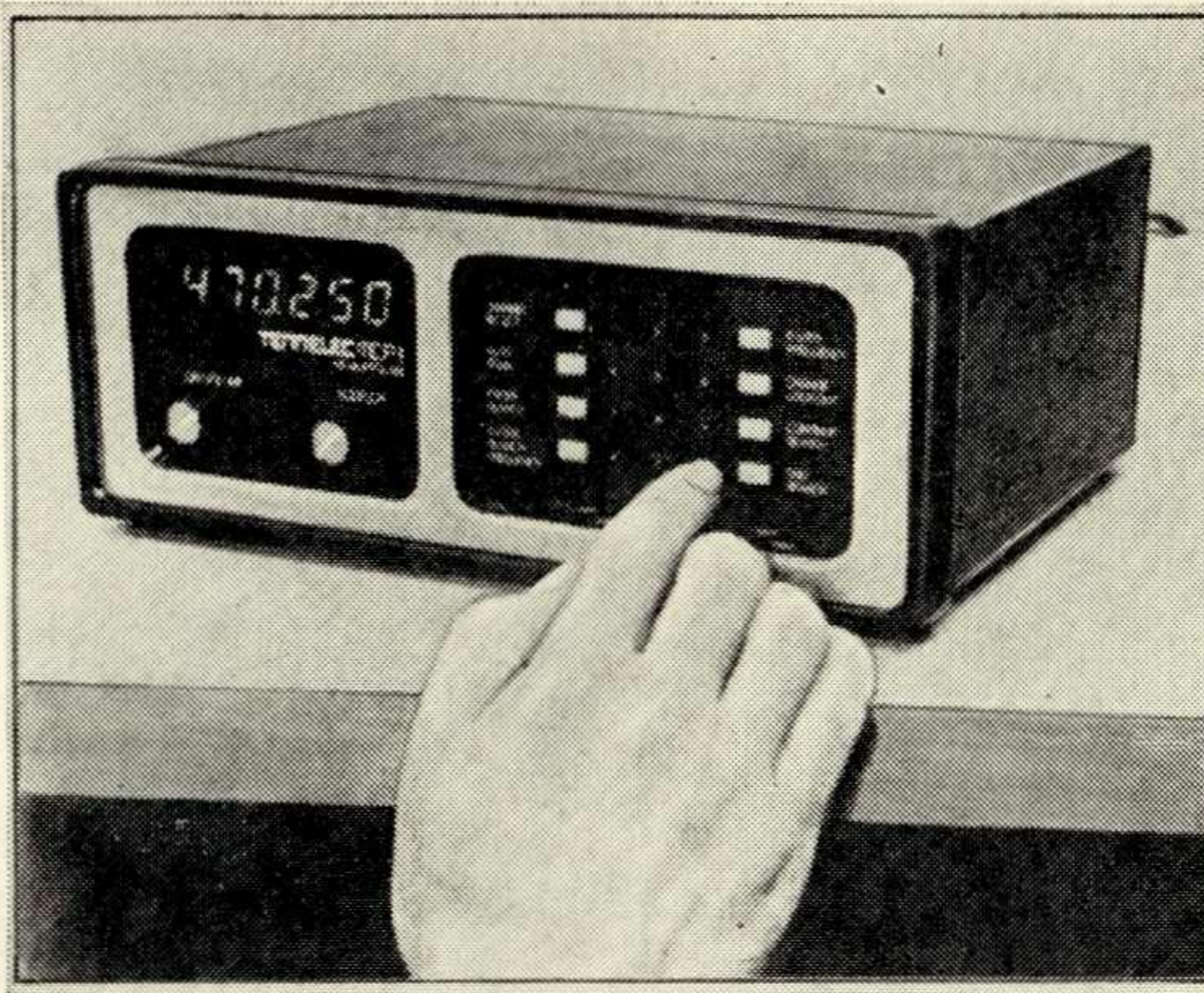
2. Приемник Tennelec MCR-1 имеет микропроцессор автоматической настройки на 16 различных частот
