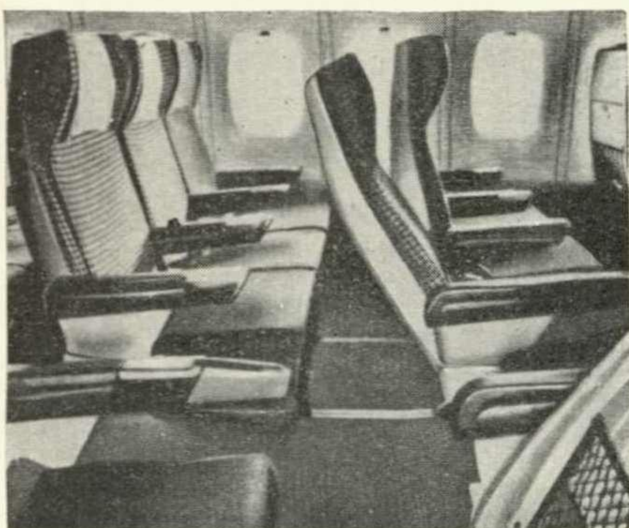
Самолет «Сьюпер VC-10» транспортной авиакомпании BOAC. Количество мест — 123. Дальность полета — 6400 км. Крейсерская скорость — 880 км. Размеры салона 31,5×3,5×2,3 м. Планировка интерьера салона: а — буфет, б — туалет.
