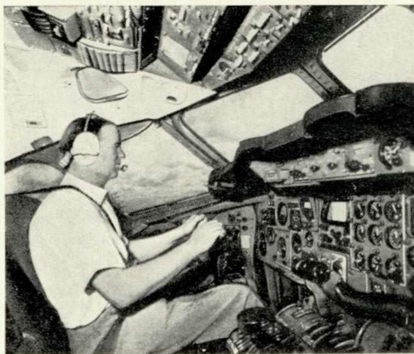
4. Рабочее место первого пилота на самолете «Трайидент». Характерную особенность представляет положение рук на штурвале. Летчик сидит в удобном кресле, имеющем привязные ремни.
