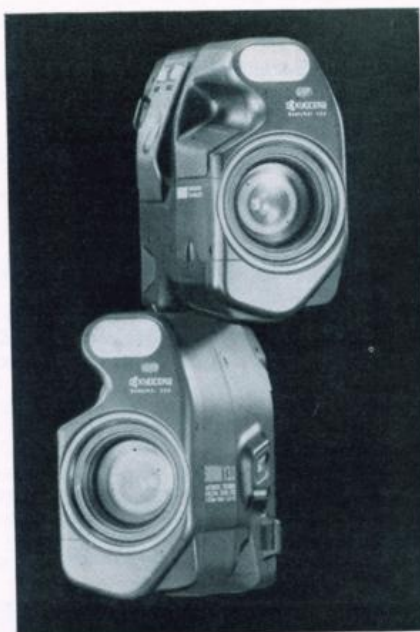
1. Однообъективный зеркальный 35-миллиметровый фотоаппарат Samourai фирмы Kyosera с ОПФ. Полный автомат. Объектив: 13 групп, 14 линз. Фокусное расстояние: 25—75 мм. Управление экспонированием: программный автомат. Диапазон экспозиции: EV1—EV18. Электронный затвор с диапазоном выдержек 2—1/500 с. Автоматическая транспортировка пленки. Габариты: 67×117×126 мм, вес 560 г. Дата выпуска 1987 г. Цена 59 800 руб
