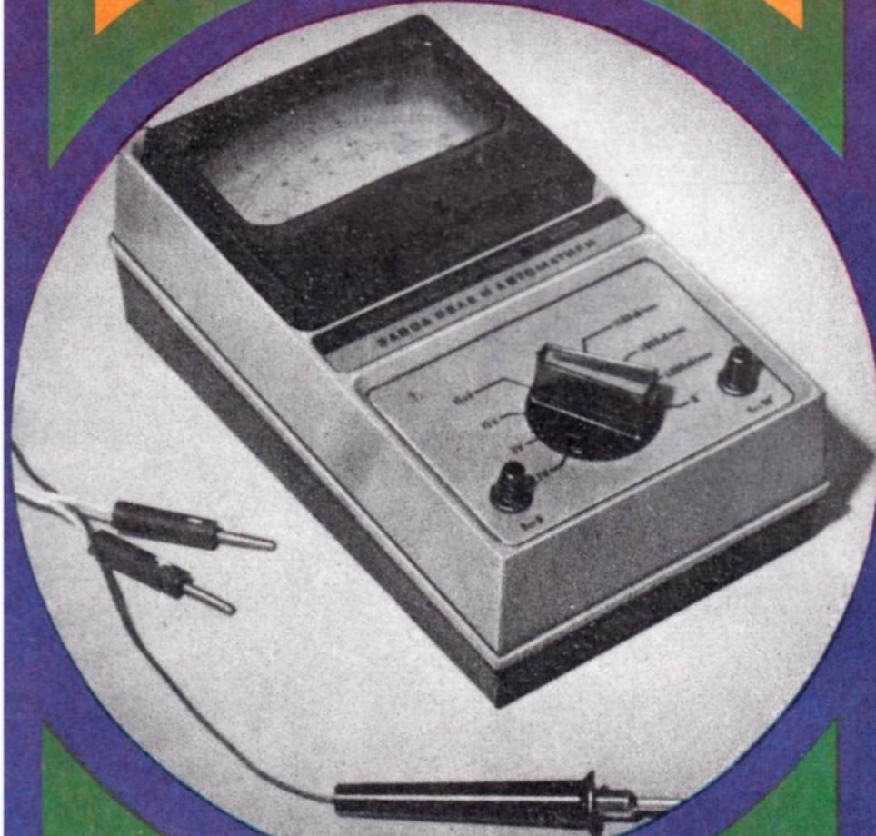
С помощью этого электронного устройства можно проверить: напряжение в системе электрооборудования автомобиля, скорость вращения коленчатого вала двигателя, угол замыкания контактов прерывателя (зазор между контактами, падение напряжения), переходное сопротивление на замкнутых контактах прерывателя, правильность регулирования прерывателя и состояние пружины его подвижного контакта, импульсное высокое напряжение на свечах зажигания.
