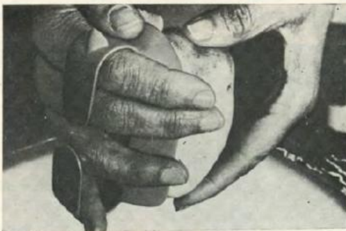
9. Картофелечистка, удобная для людей с ограниченной двигательной функцией рук. Она исключает необходимость держать в руках рукоятку ножа: нож и другие насадки, например терка, вдеваются в кольцо, обхватывающее кисть
