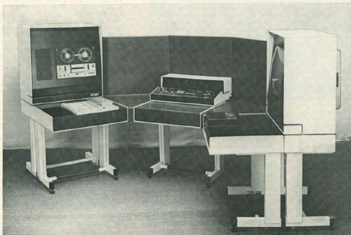
1—3. Экспериментальный диагностический пульта-тренажер: 1 — пульт управления экспериментом, 2 — рабочее место исследователя, 3 — рабочее место испытуемого.
