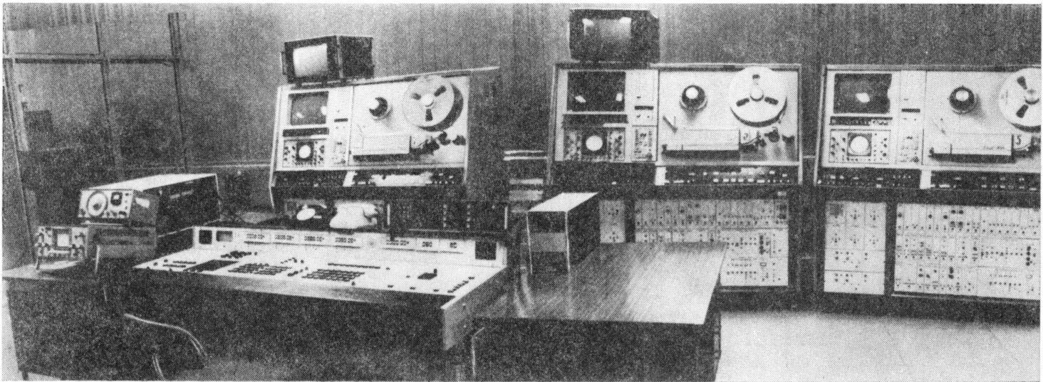
Аппаратная видеозаписи. Видеомагнитофоны «Кадр-3ПМ»
