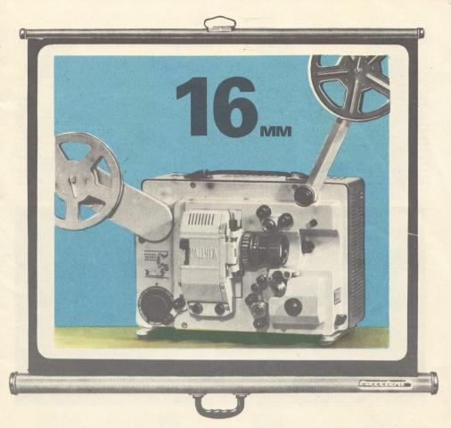
Киевский завод «Кинап» в 1970 г. начнет серийное производство портативного кинопроектора «Радуга», предназначенного для демонстрации черно-белых и цветных 16-мм звуковых кинофильмов с оптической и магнитной фонограммами. Прерывистое движение кинофильма в проекторе осуществляется грейферным механизмом. Скорость проекции 24 кадра/сек. Кинопроектор рассчитан на работу с бобинами емкостью 120 и 600 м фильма. Перемотка фильма ручная, на проекторе.
