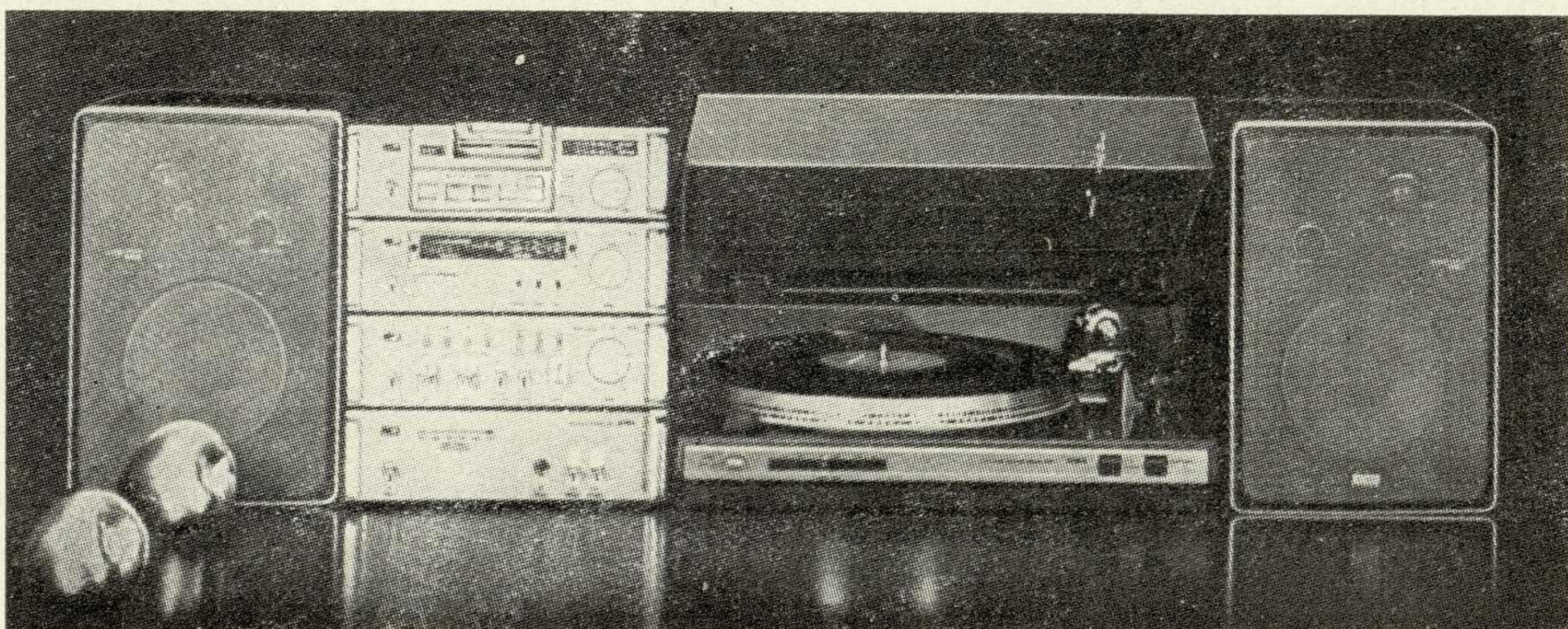
7. Общий вид радиоэлектронного комплекса фирмы Aiwa. Акустические колонки увязаны по высоте с высотой «штабеля» из четырех блоков: предварительного усилителя, усилителя, тюнера и магнитофона. Несмотря на удачное в целом художественно-конструкторское решение комплекса, проигрыватель несколько выпадает из единого стилевого ключа в решении изделия. Однако при размещении отдельных блоков в различных участках интерьера этот недочет практически незаметен
