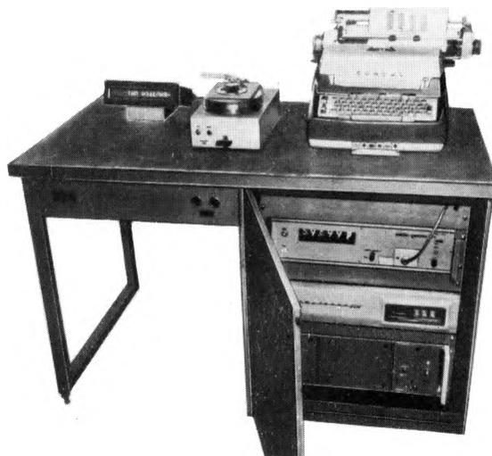
Разработанная на базе микроЭВМ «Электроника 60М» система АС-401 включает следующие устройства: цифровой омметр «Щ-34»; стенд с шаговым двигателем ЭПШ 50/1800 для установки проверяемого потенциометра; ЭПМ «Консул-260»; однострочный дисплей ПИУ-2 на 16 знакомест алфавитно-цифровой информации; блок питания и сопряжения; устройство для юстировки потенциометров.
