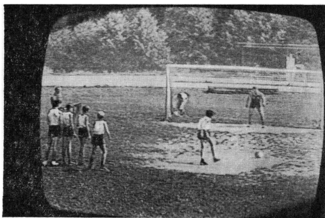
Рис. 1. Кадр, полученный при киносъемке экрана кинескопа с помощью КСА ЗКСР (обтюратор с нижним расположением оси вращения, \alpha_0 = 173^\circ , \beta = 37^\circ )
