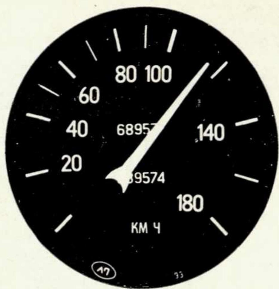
5. Разноразмерная шкала варианта III: до 100 км/ч цена оцифровки 20 км/ч, в диапазоне 100—180 км/ч. Цена оцифровки 40 км/ч. В секторе шкалы 60—100 км/ч имеются неоцифрованные деления, соответствующие 10 км/ч. Шрифт новый № 2
