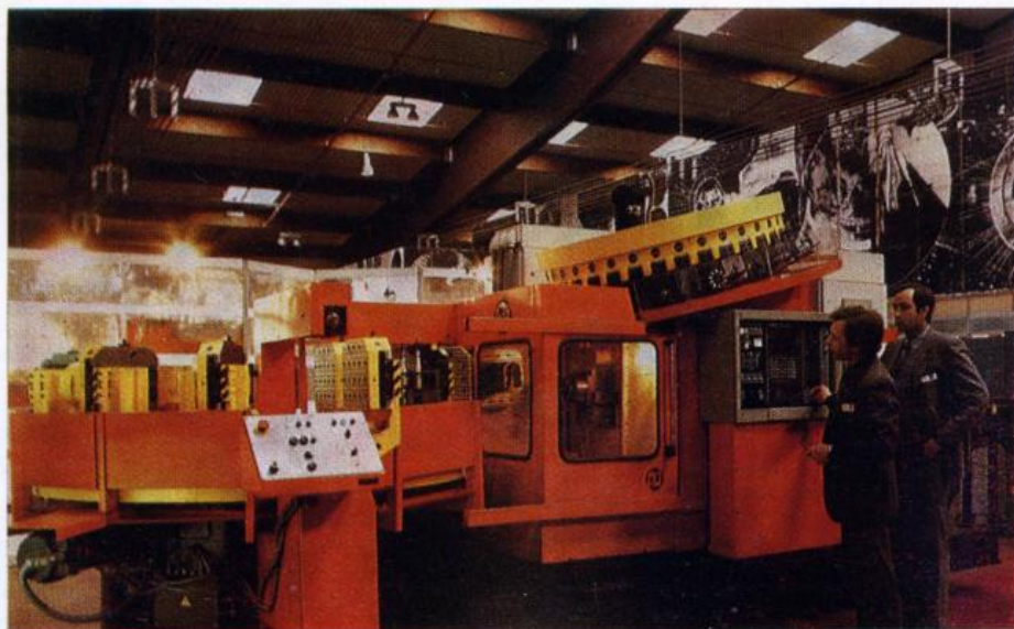
3. Многоцелевой станок «Модуль ИР320ПМФ4». СКБ расточных станков Ивановского станкостроительного ПО. Конструкторы и дизайнеры: В. П. КАБАИДЗЕ, К. Я. ФИРСОВ, Э. Д. БРОМБЕРГ, Ю. В. МАСЛОВСКИЙ, С. Е. ГУРЫЧЕВ, Ю. В. БАНКОВСКИЙ, В. Л. ПЕТУХОВ
