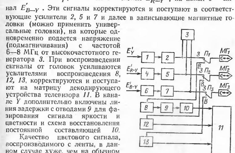
Рис. 60. Структурная схема видеомодулятора-приставки для раздельной записи сигнала яркости и цветоразностных сигналов на трех параллельных дорожках.
