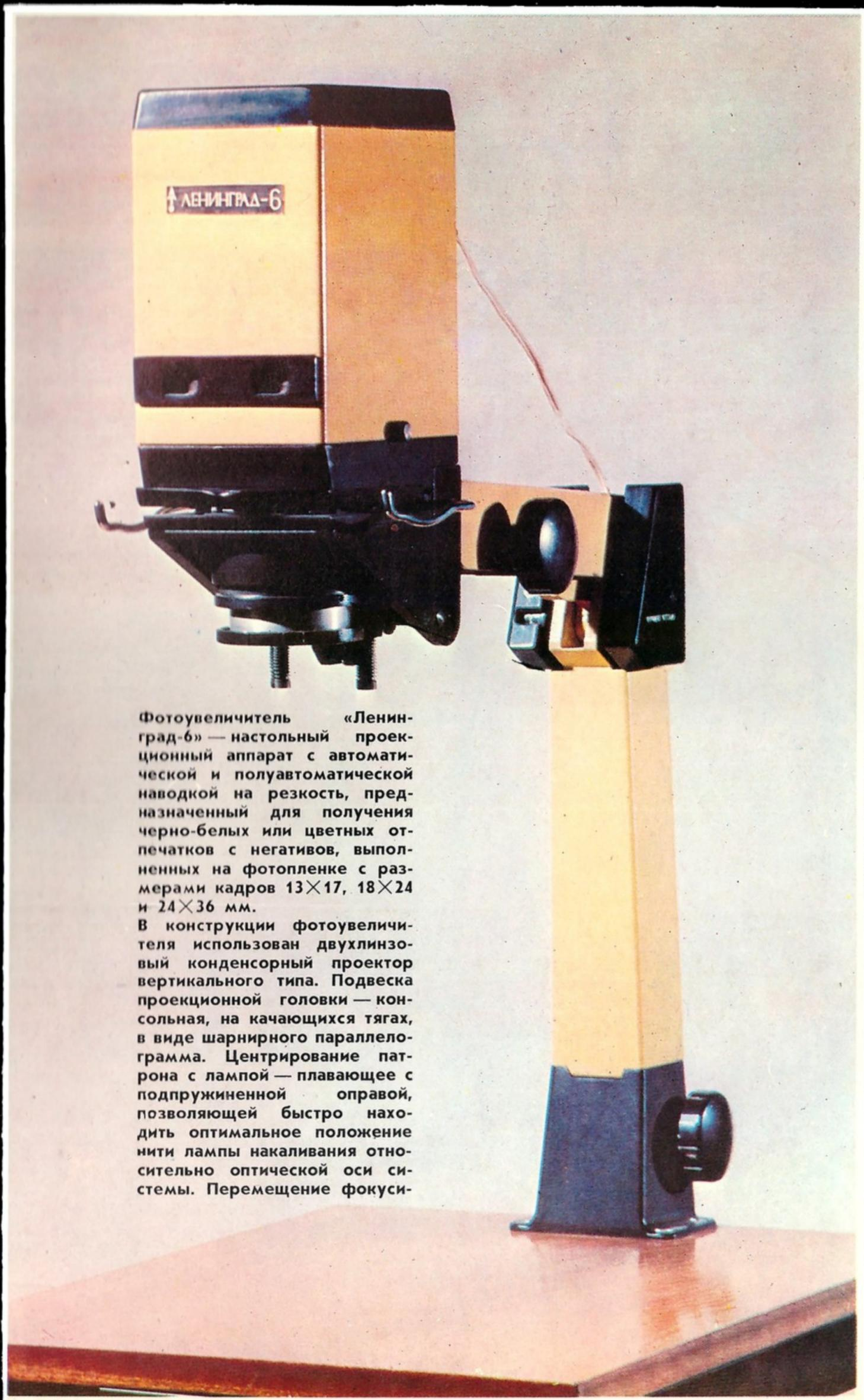
Фотоувеличитель «Ленинград-6» — настольный проекционный аппарат с автоматической и полуавтоматической наводкой на резкость, предназначенный для получения черно-белых или цветных отпечатков с негативов, выполненных на фотопленке с размерами кадров  $13 \times 17$ ,  $18 \times 24$  и  $24 \times 36$  мм.
