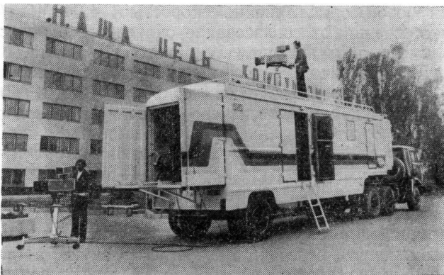
Рис. 10. Развернутая станция ПТВС-ЗЦТ
