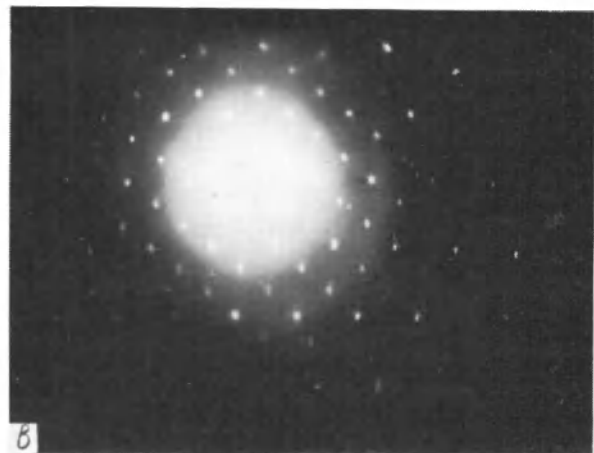
Рис. 5, в. Электронограмма от частиц кремния, выпавших по границам зерен алюминия, полученного термическим напылением на кремний при T_{\text{подл}} = 200^{\circ}\text{C} и T_{\text{отж}} = 500^{\circ}\text{C}
