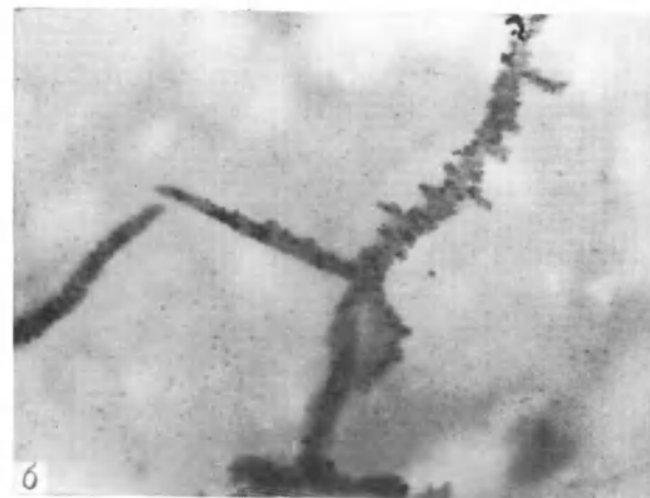
Рис. 5, б. Частицы кремния по границам зерен отожженных пленок алюминия ( \times 50000 ) при T_{\text{подл}} = 200^{\circ}\text{C} и T_{\text{отж}} = 500^{\circ}\text{C}
