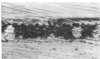
Рис. 3. Структура микрошлифа паяного шва корпуса с электрохимическим никелированием основания, загерметизированного крышкой с тонким лужением ПЭС-61 и самофлюсующей композитной пастой ( \times 100 )
