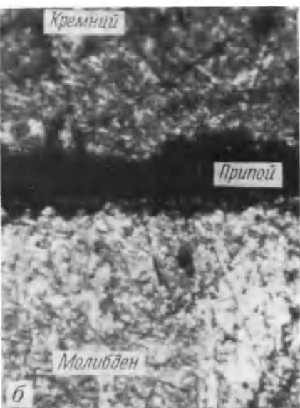
Шлифы блоков арматуры мощного транзистора при пайке кристалла к молибденовому компенсатору припоем AuSi (а) и припоем AlGe (б)
