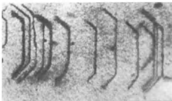
Рис. 2. Топограмма монокристалла кремния с введенными при пластической деформации дислокационными полупетлями. Толщина кристалла 0,5 мм; излучение \text{MoK}\alpha ; отражение (220); время экспозиции 10 ч
