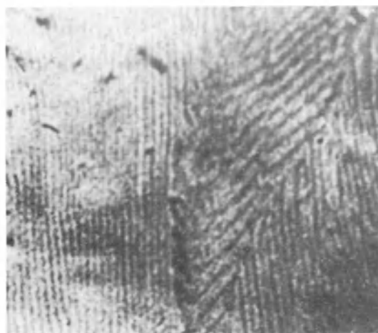
Рис. 4. Фрагмент топограммы железо-иттриевого граната. Толщина кристалла 180 мкм; излучение \text{AgK}\alpha , отражение (800); время экспозиции 60 ч
