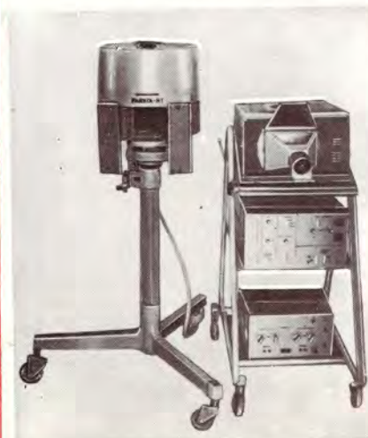
Рис. 1. Цветной быстросканирующий тепловизор «Радуга»
