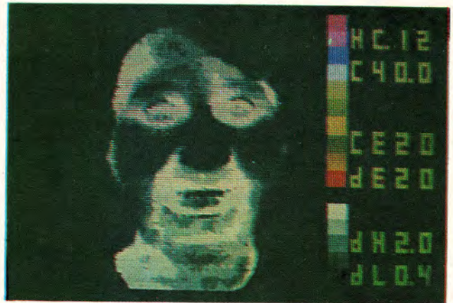
Рис. 3. Термограмма, полученная при работе тепловизора в режиме черно-белого изображения
