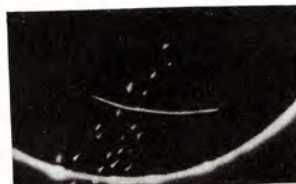
Рис. 3. Автораддиограмма пленки двуокиси кремния, осажденной из раствора
