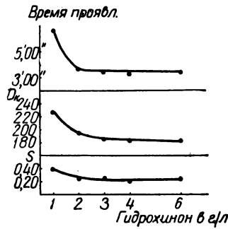
Рис. 6. Изменение продолжительности проявления до \gamma = 2,0 и достигаемых при этом величин S и D_k в зависимости от концентрации гидрохинона в проявителе
