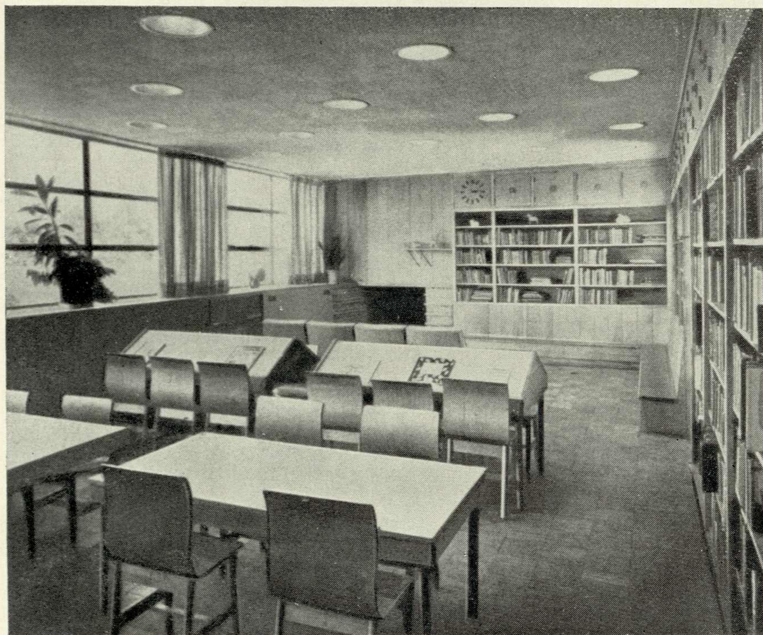
Читальный зал школы со встроенными стеллажами вдоль стен. Часть книжных полок встроена под окнами. Угловая часть стеллажа соединена со встроенной скамьей. Школа в Кроу Айленд, США.
