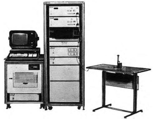
Рис. 12. Автоматизированная установка «Момент» для измерения продольной и радиальной составляющих магнитной индукции кольцевых магнитов
