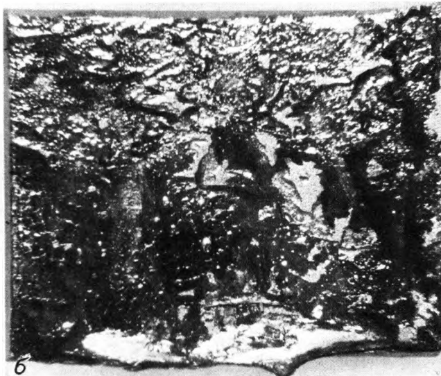
Рис. 2. Голографическая интерферограмма качественной посадки кристалла СБИС (а), обратная сторона кристалла, напаянного по усовершенствованной технологии (б)
