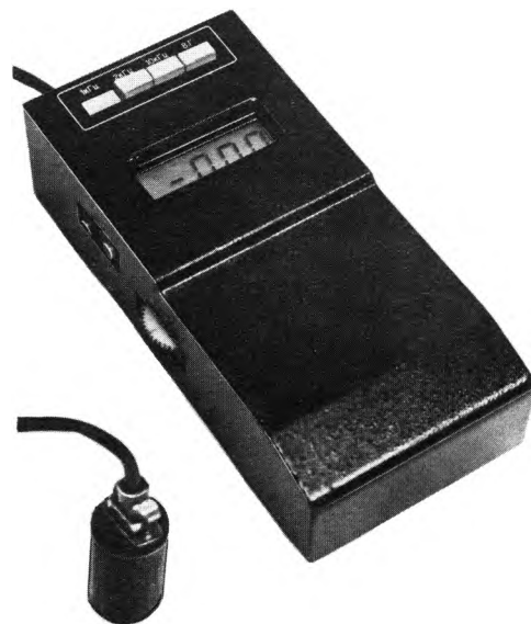
Рис. 2. Прибор для измерения напряженного состояния деталей из ферромагнитных материалов: 1 — прибор; 2 — датчик
