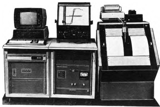
Рис. 1. Автоматизированная установка «Меридиан-2» для измерения магнитных параметров образцов магнитотвердых материалов с малой массой
