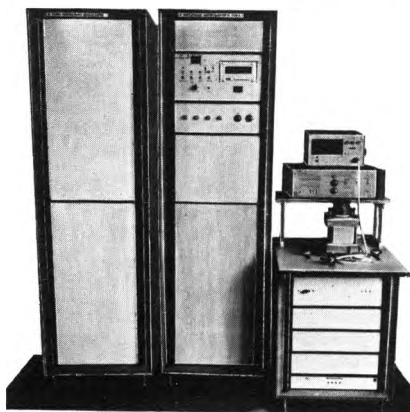
Рис. 3. Установка «Мишень» для намагничивания, размагничивания до заданного уровня и контроля магнитной индукции постоянных магнитов
