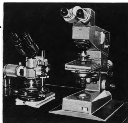
Рис. 1. Микроскопы ММУ-3 (слева) и «Eriyal» с НЖК зондовыми приставками
