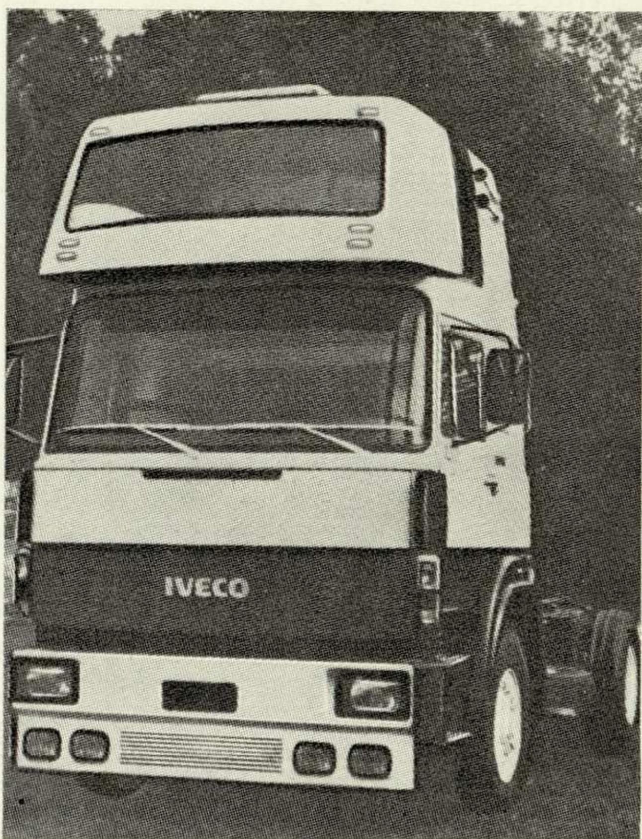
1—4. Двухместная кабина повышенной комфортности грузового автомобиля для дальних перевозок (общий вид и фрагменты интерьера). Кабина оснащена кухонным и санитарно-гигиеническим блоками и спальным отсеком, расположенным над рабочим местом водителя. Премия «Золотой циркуль». Дизайнер Ф. Кварингетти. Фирма-изготовитель Ivesco (Италия)
