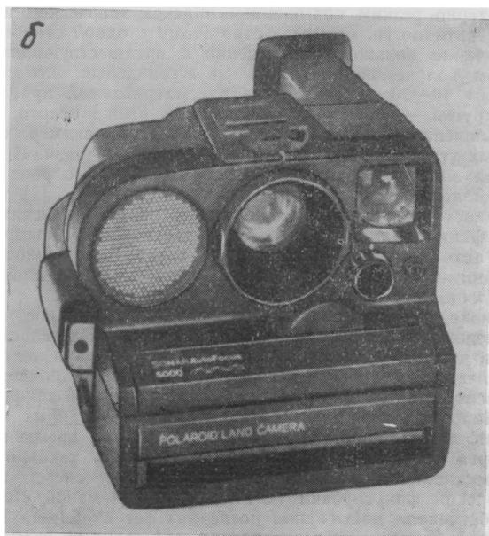
Рис. 1. Устройство автоматической фокусировки Polaroid Sonar в фотоаппаратах Polaroid One-Step (а) и Sonar AF 5000 (б)
