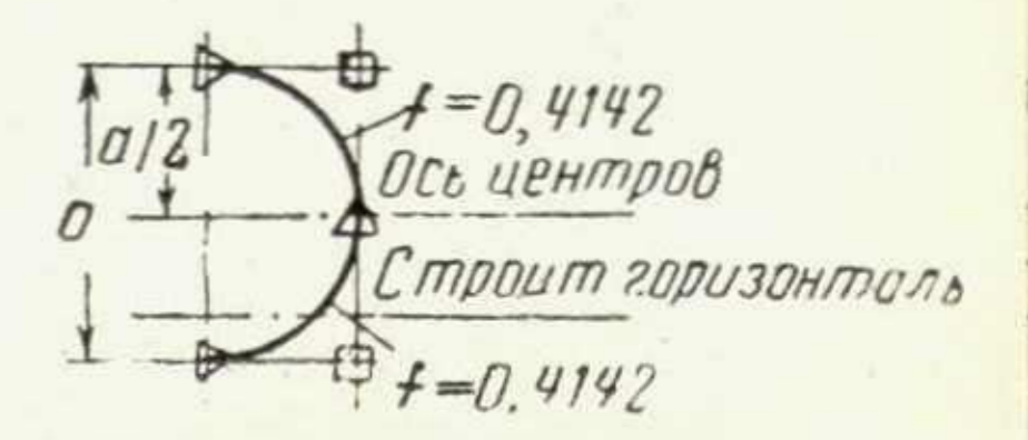
Построение сечений от В—В до конца фюзеляжа
