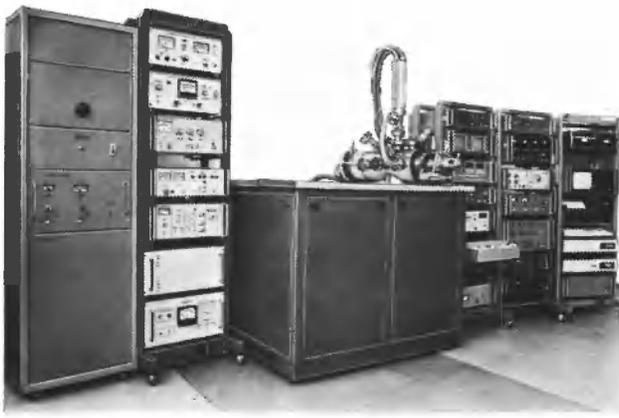
Рис. 1. Комплексная установка для анализа поверхности методами рентгено-электронной и оже-спектроскопии
