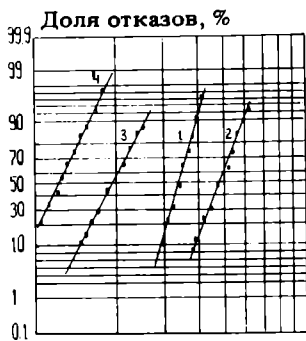
Рис. 3. График зависимости доли отказов от логарифма времени наработки \tau для образцов серии (А) и (Б) при j=1,2 \cdot 10^6 А/см 2 , T=160-170^\circ\text{C} : 1 — TiW—AlSi(1%) с пассивацией ПХО+пиролитический SiO 2 (серия А); 2 — TiW—AlSi(1%) с пассивацией полиимид (серия А); 3 — TiW—AlSi(1%) с пассивацией ПХО+пиролитический SiO 2 (серия Б); 4 — TiW—AlSi(1%) с пассивацией полиимид (серия Б)
