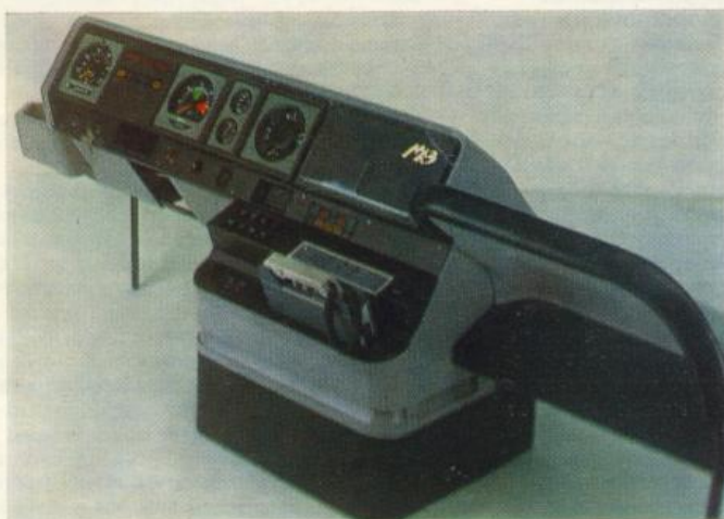
1—3. МАЗ-2000 «Перестройка». Кабина автомобиля, щиток приборов и интерьер кабины. Кабина одновременно выполняет роль аэродинамического обтекателя
