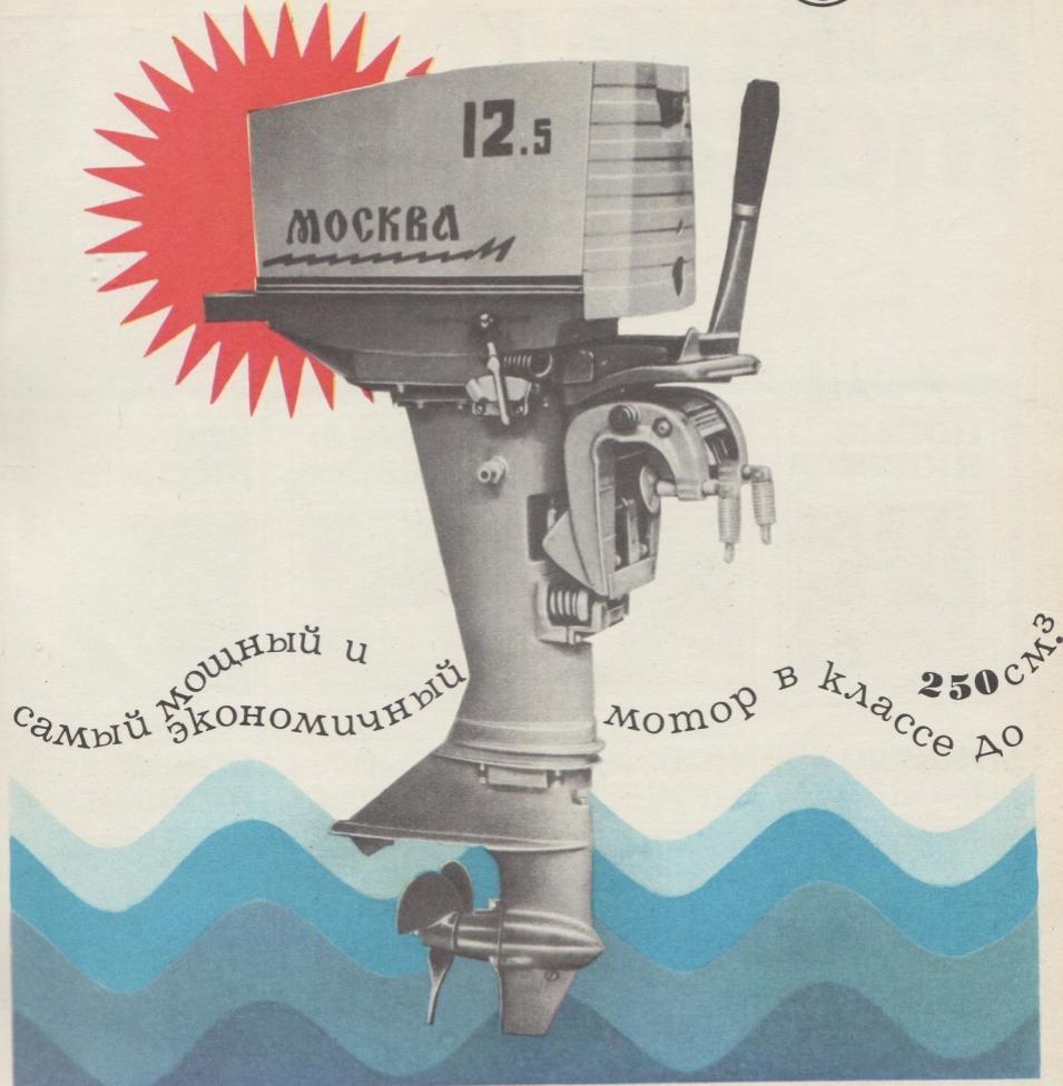
Этот мотор серийно выпускает Ржевский моторный завод. При рабочем объеме цилиндров 244 см<sup>3</sup> двигатель развивает мощность 12,5 л. с. с удельным расходом топлива 388 г на одну лошадиную силу в час.
