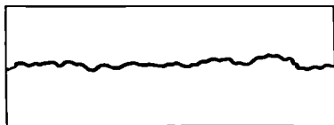
Рис. 59. Профилограмма поверхности видеоленты PEV 4000 в поперечном направлении. Средняя высота неровностей на данном участке 0,05 мкм.
