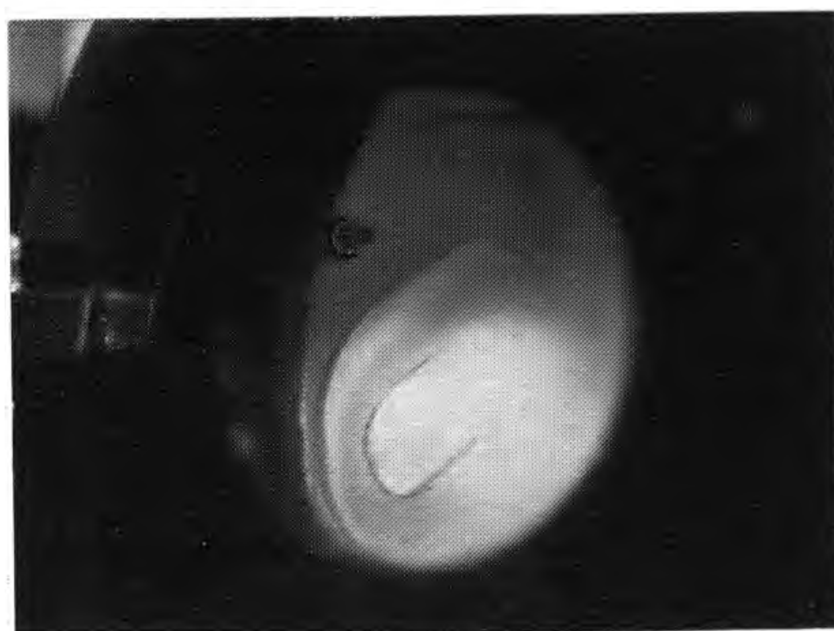
Рис. 2. Разряд в ускорителе овально-протяженной геометрии (рабочий газ — аргон)
