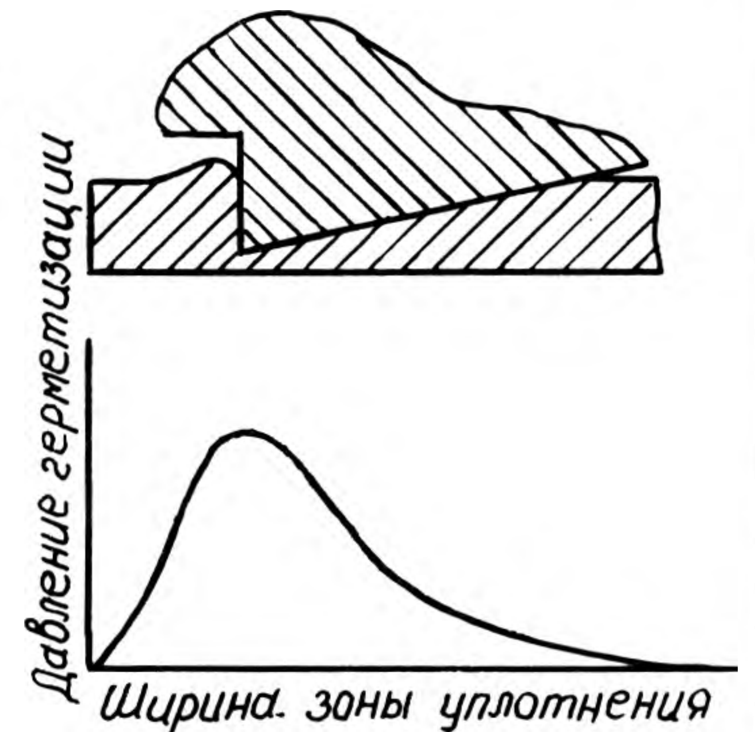
Рис. 2. Напряжения сжатия в зоне уплотнения соединений CF [7, 8]
