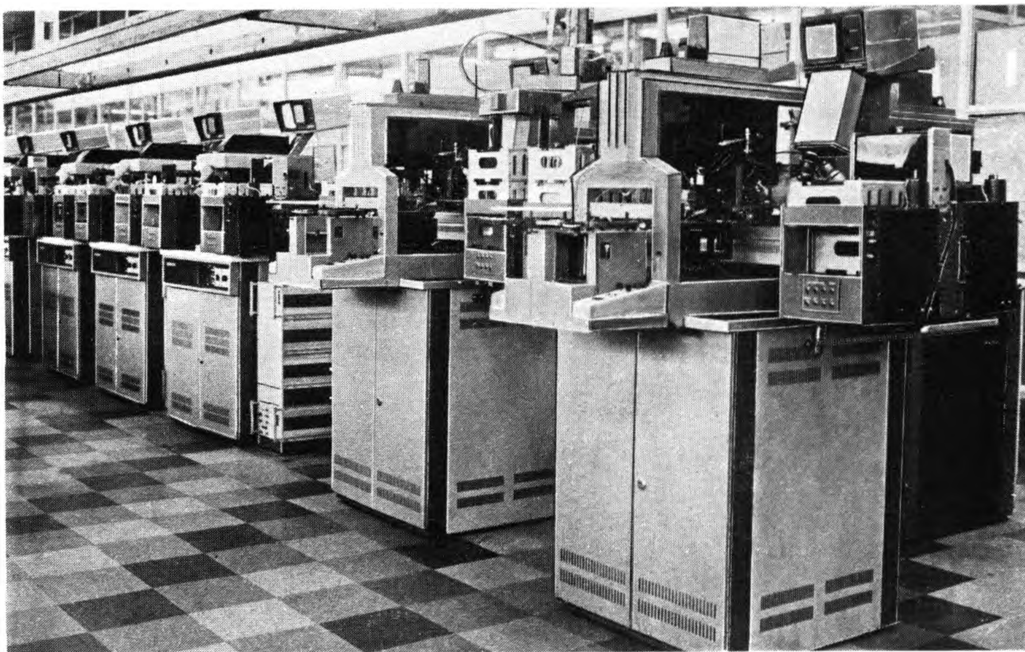
Рис. 8. Линия сборки ИС в пластмассовых ДИП-корпусах
