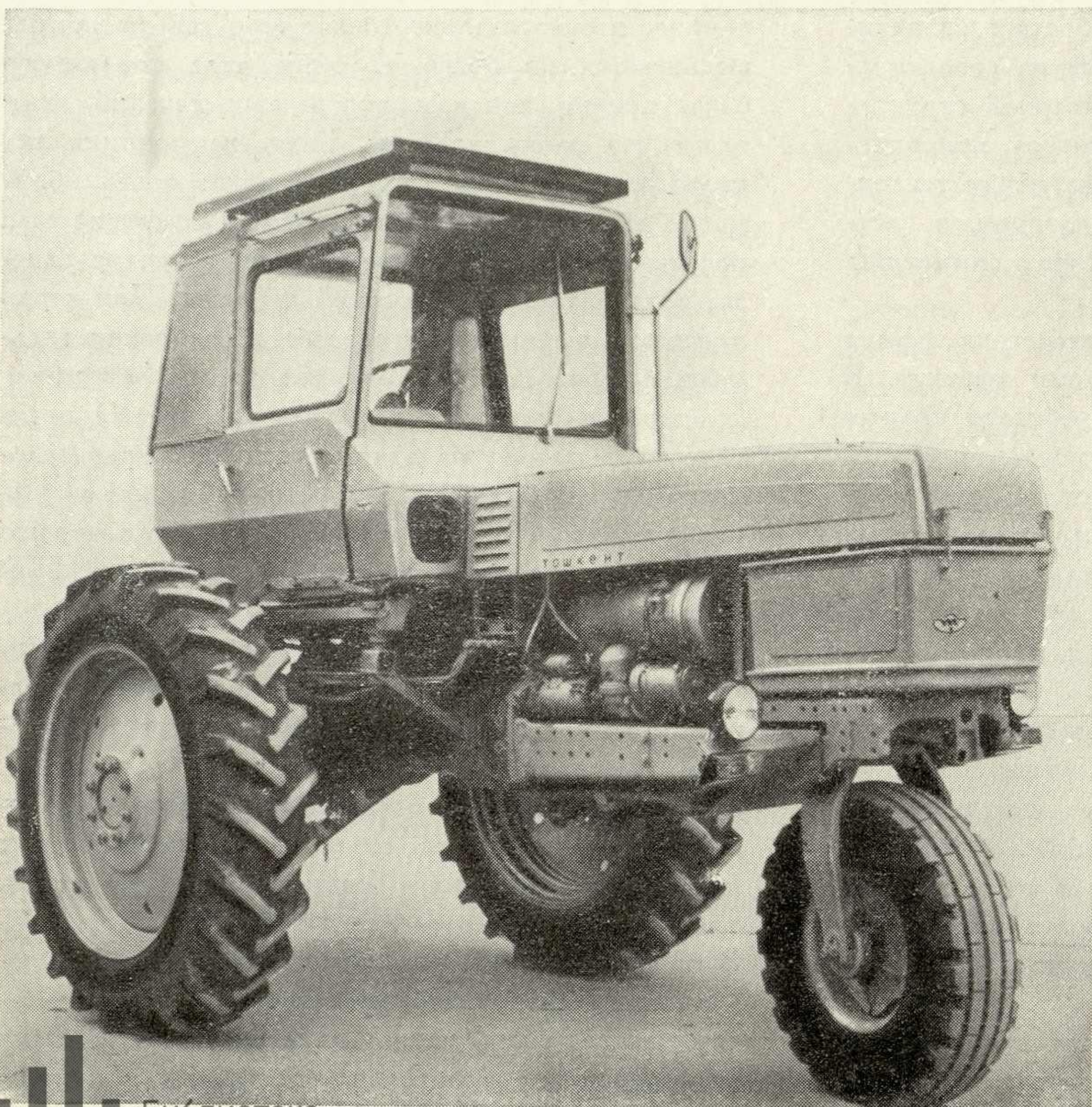
1 Универсально-пропашной трактор класса 1,4 т. «Беларусь» МТЗ-80. 3 Хлопководческий трактор класса 0,9 т. «Тошкент» 55Х.
