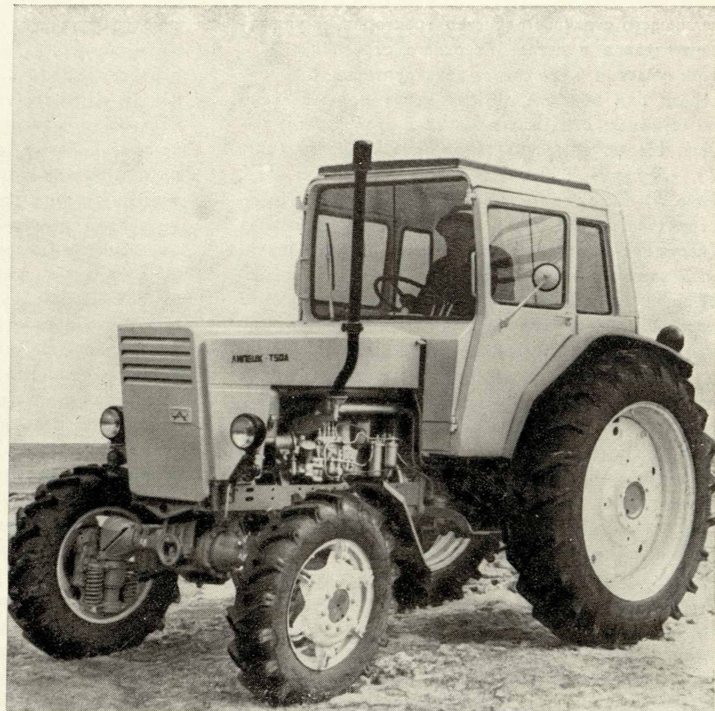
2 Универсально-пропашной трактор класса 0,9 т «Липецк» Т50А. 4 Модель трактора Т-150ТЭ (колесный вариант).
