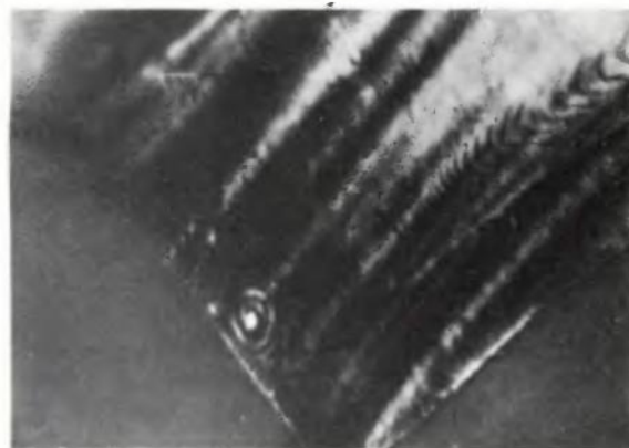
Рис. 5. Частицы второй фазы (а) и периодические поля упругих напряжений (б) в монокристаллах кремния. Снимки сделаны с телеэкрана лазерного инфракрасного поляризационного микроскопа
