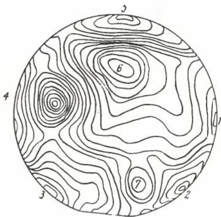
Рис. 3. Вид интерференционных полос равной высоты при широкоугольной интерференции от реальной поверхности пластины: 1—4—вершины; 5—7—впадины
