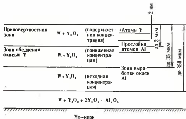
Рис. 7. Схема зонального распределения основных компонентов металлокерамических катодов в процессе работы
