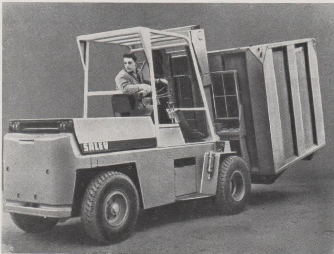
Пятитонный погрузчик фирмы Salev. Модель разработана совместно с художественно-конструкторским бюро Technès. Все элементы формы определяются их функциональным назначением. Фонари над противовесом защищены капотом.
